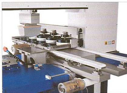
Die neue TPX 555 druckt mehrfarbig mit einer Genauigkeit im 100stel Millimeterbereich.
