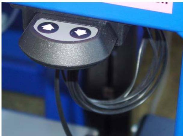
Photo: Höhenverstellung erfolgt per Knopfdruck. Der Schalter selbst ist in einer Führung angebracht. Somit ist es möglich, den Schalter in der Führung zur Bedienung aus dem Gestell heraus nach vorne zu schieben und ihn dann wieder zurückzuschieben, so dass er nicht über das Gestell herausragt.
