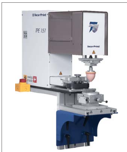
Fig. 1: Machine de tampographie TPE 150. La machine peut recevoir des clichés de 100 x 100 mm à 150 x 220 mm. La cadence maximale de production est de 1800 pièces à l'heure.
